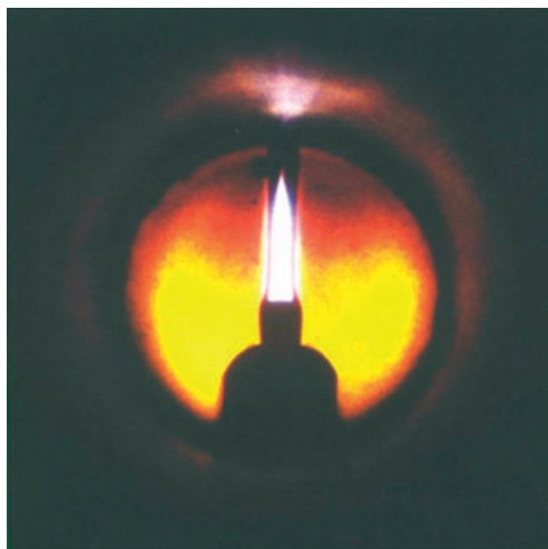
Abbildung 1. Durch das Saphirfenster eines Autoklaven beobachtete Hydrothermalflamme in einem überkritischen homogenen Gemisch von 70 Mol-% Wasser und 30 Mol-% Methan bei 100 MPa und einer Umgebungstemperatur von 713 K. [8a] Von unten strömt über eine Düse Sauerstoff mit einer Geschwindigkeit von 3 \text{ mm}^3 \text{ s}^{-1} ein. Die Höhe der Flamme beträgt ca. 3 mm. Der Gas-Trichter um die Flamme und oberhalb davon resultiert aus dem Aufwärtsfluss der Reaktionsprodukte höherer Temperatur und niedrigerer Dichte, die einen Schlierenkontrast ergeben. Es tritt keine Phasentrennung auf.
